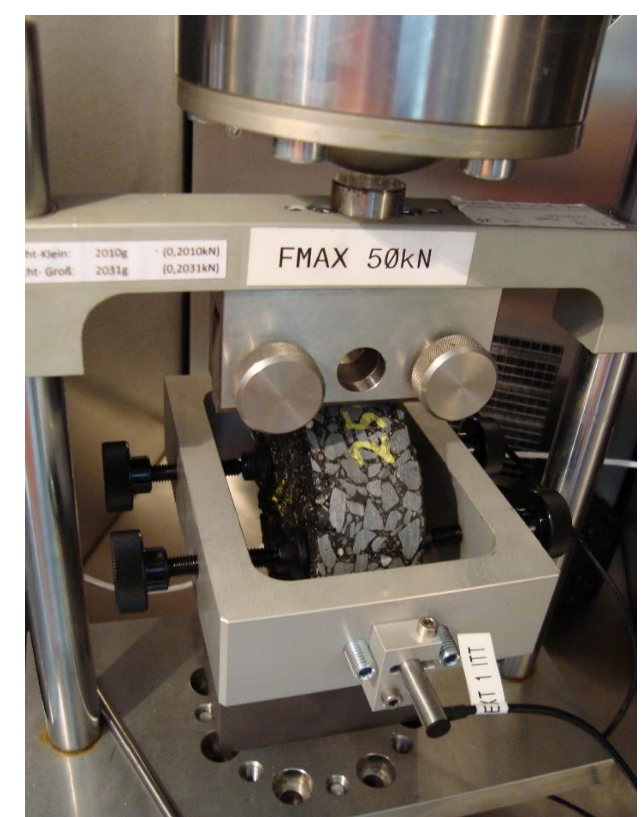
Prüfvorrichtung Spaltzug-Schwellversuch (Ermüdungs- und Steifigkeitseigenschaften)
