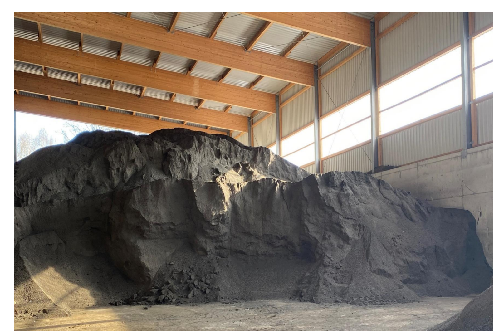
Lagerung von Asphaltgranulat unter Dach
