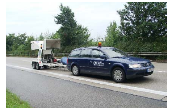
Tragfähigkeitsuntersuchungen mit dem Falling Weight Deflectometer
