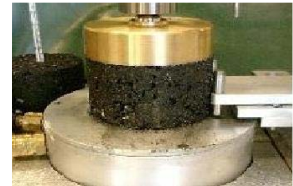
Druckschwellversuch an Asphaltprobekörpern
