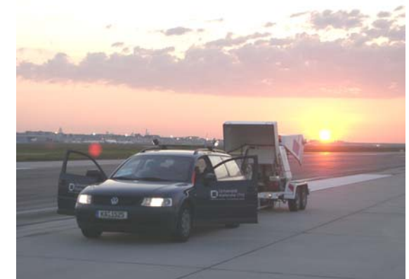
FWD-Messung zur Tragfähigkeit
