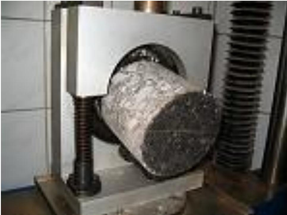
Der Abscherversuch zur Überprüfung des Schichtenverbundes zwischen Asphaltsschichten (Prüfpräzision).
