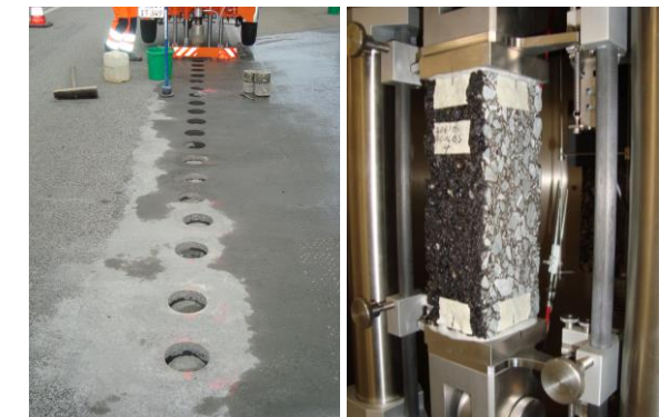
Bestimmung der Performance-Eigenschaften an Bohrkernen
